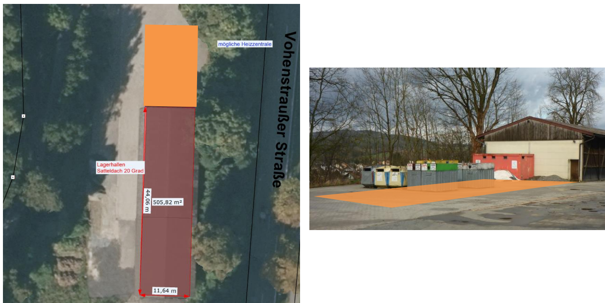
Abbildung 9: Möglicher Standort Heizzentrale im Anschluss an Lagergebäude (Quelle: Stadt Pleystein; Bayerische Vermessungsverwaltung; Bearbeitung: IfE GmbH)
